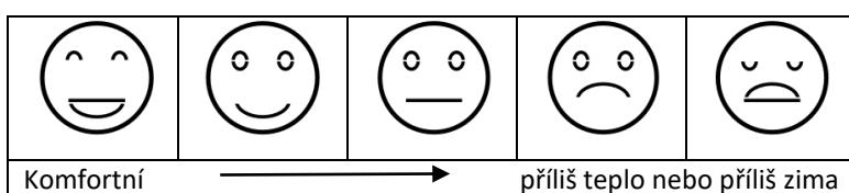
Funkce pocitového komfortu vychází z měření teploty, tlaku a vlhkosti. Na základě těchto měření určuje stanice předpokládané vnímání vnitřního prostředí z pěti možností (viz. obr.).
